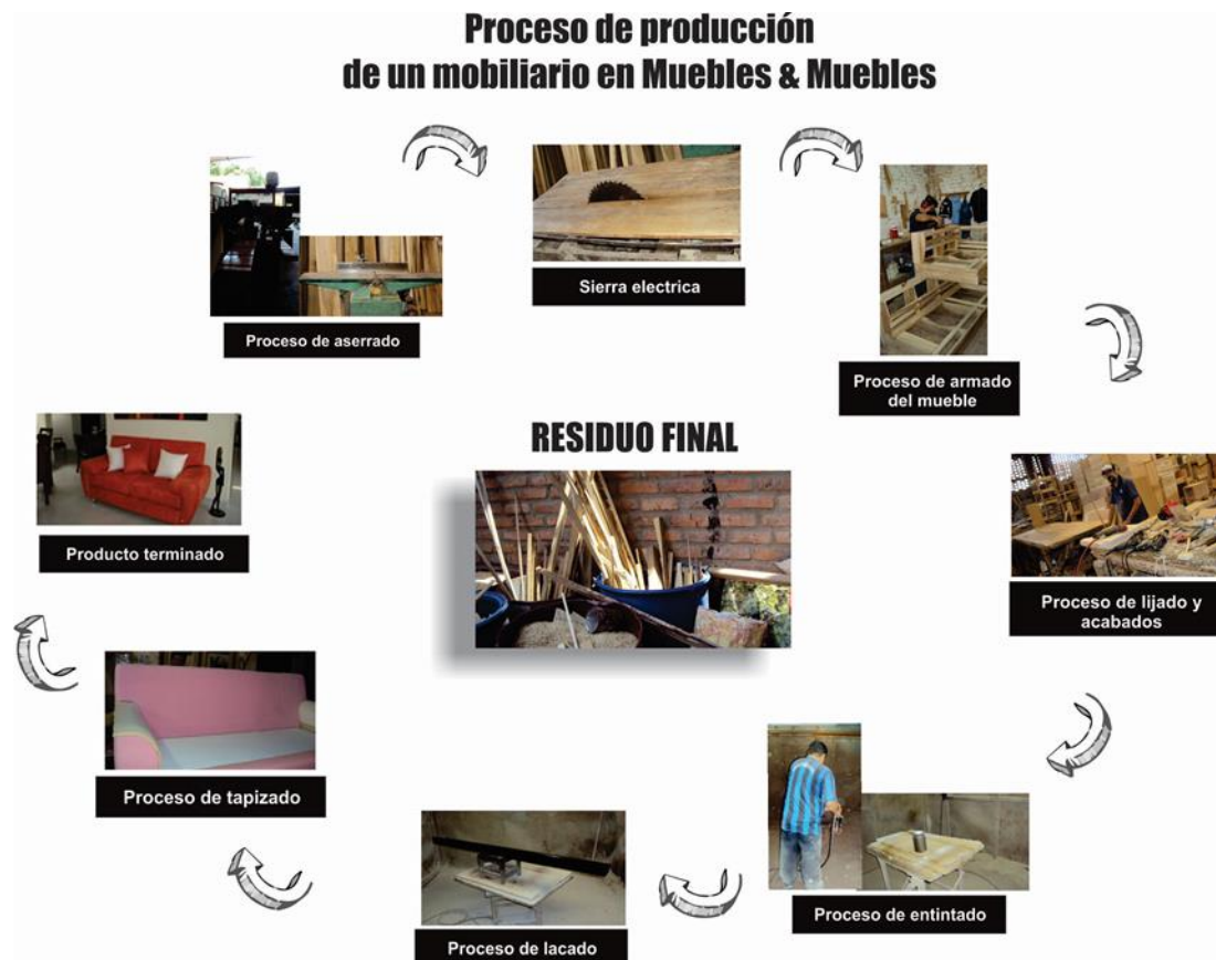
Ilustración 8. Proceso de producción M&M. Fuente: Propia Los Autores (2018)
