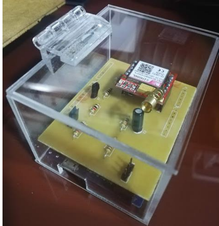
Figura 44 Diseño final de caja
