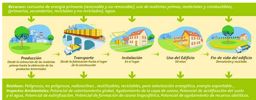
Figura 1 Ciclo de vida de una edificación
