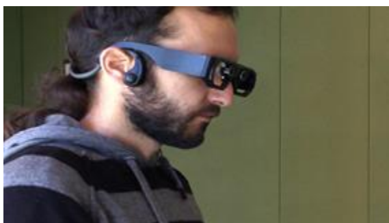
Figura 1 Prototipo sónico de ayuda a la ceguera en uso
