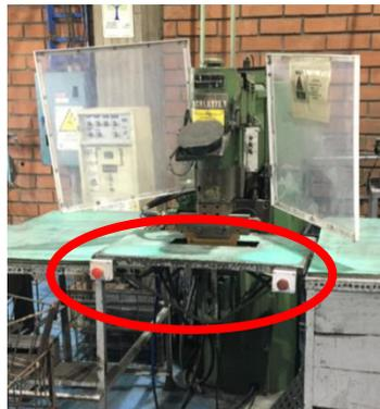
Los equipos con puntos de operación que permiten el acceso a manos permanecen descubiertos y su accionamiento es de pedal.
