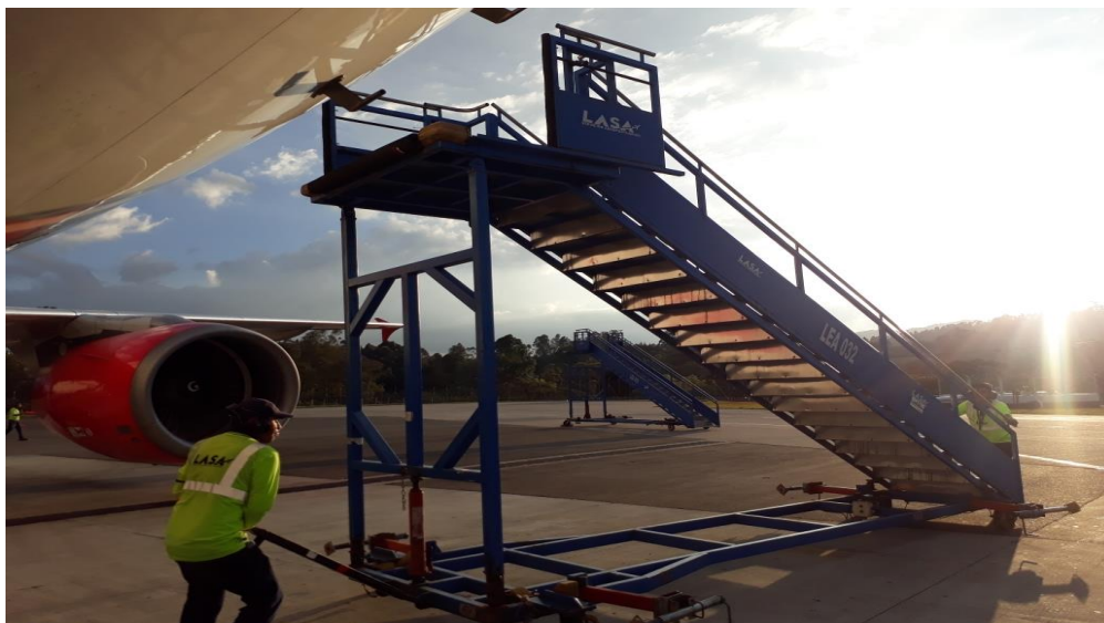
Figura 9: área rampa, colocación de la escalera manual en el avión para el descenso de las personas.
