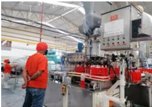
a) Proceso de llenado de las bebidas carbonatadas en envase Pet.
